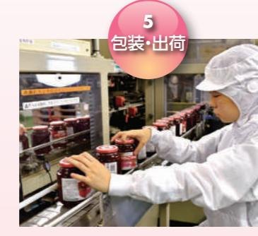
ラベルを貼った後、透明フィルムでシール包装を行い、段ボール箱に詰めて、出荷を行います。
