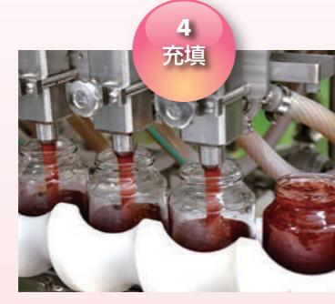
完成したジャムを洗浄済みの清潔な瓶に充填します。その後、殺菌・冷却します。
